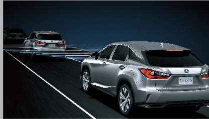
DRCC 雷達感應式車距維持定速系統 Dynamic Radar Cruise Control System
