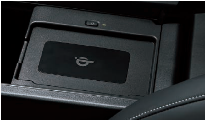
智慧型手機無線充電介面 (AWD F SPORT 版、旗艦版專屬) 於中央扶手內設有手機無線充電介面，您可將支援 Qi 無線充電介面的手機放置此處充電，加大的凹槽式設計讓手機不易位移而影響充電功能；或也可關閉充電按鈕，將此處空間變成置物處。
